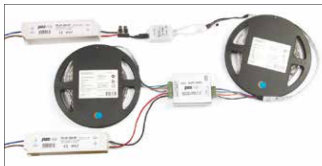
Примеры подключения усилителя мощности
